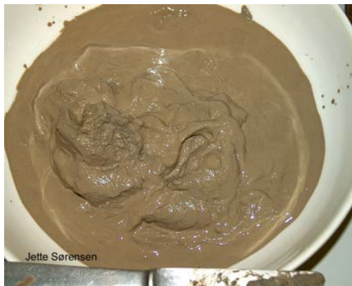
Figur 1.3c. Prøve løsboret med rullemejsel i lufthæveboring.
