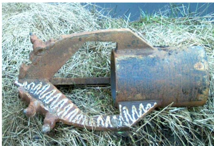
Figur 1.4. Eksempel på vinge-mejsel. Foto: Jette Sørensen
