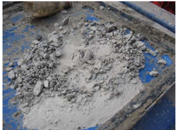
Figur 1.10. Prøve fra DTH boring i kalk og flint. GEO-Aarsleff JV. Foto: Jette Sørensen
