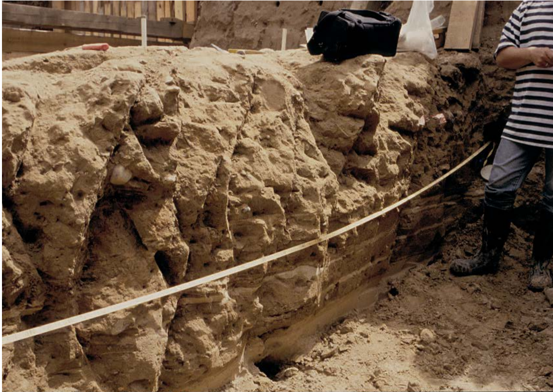
Fig. 9 Sprækkernes position (placing beskrives i forhold til en skæringspunktet på en referencelinie (her et målebånd). Spacing beregnes denne dybde. Man gentager derefter proceduren i typisk 3 dybde intervaller 2-3,5 og 5 meter under terræn.
